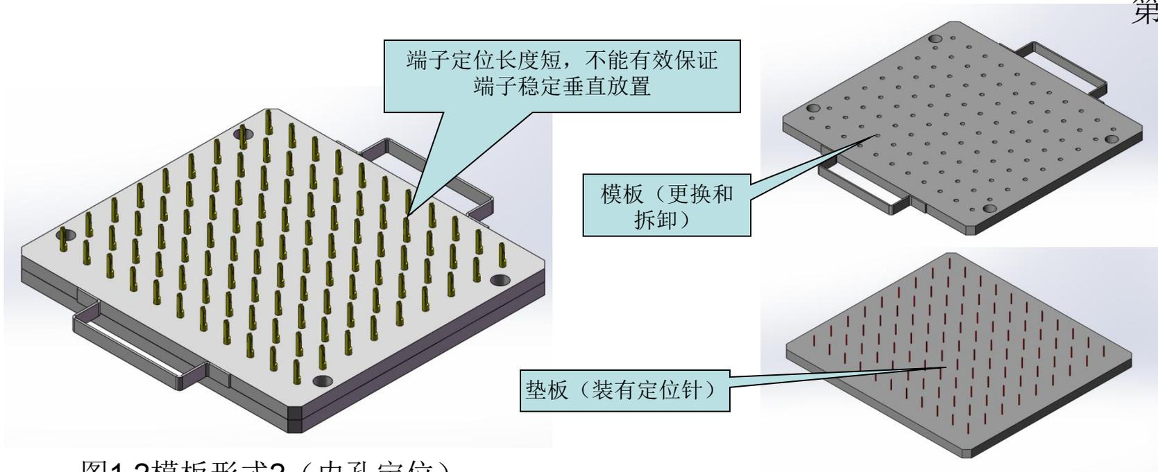
图1.2模板形式2（内孔定位）
